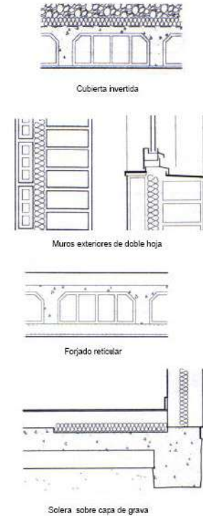
convencional (estructura de hormigón armado) Detalles constructivos del sistema convencional. CTE-HE Ahorro de energía. Aplicación a edificios de uso residencial Vivienda-DAV. Monografías CTE. 2da edición revisada. Consejo Superior de los Colegios de Arquitectos de España.
